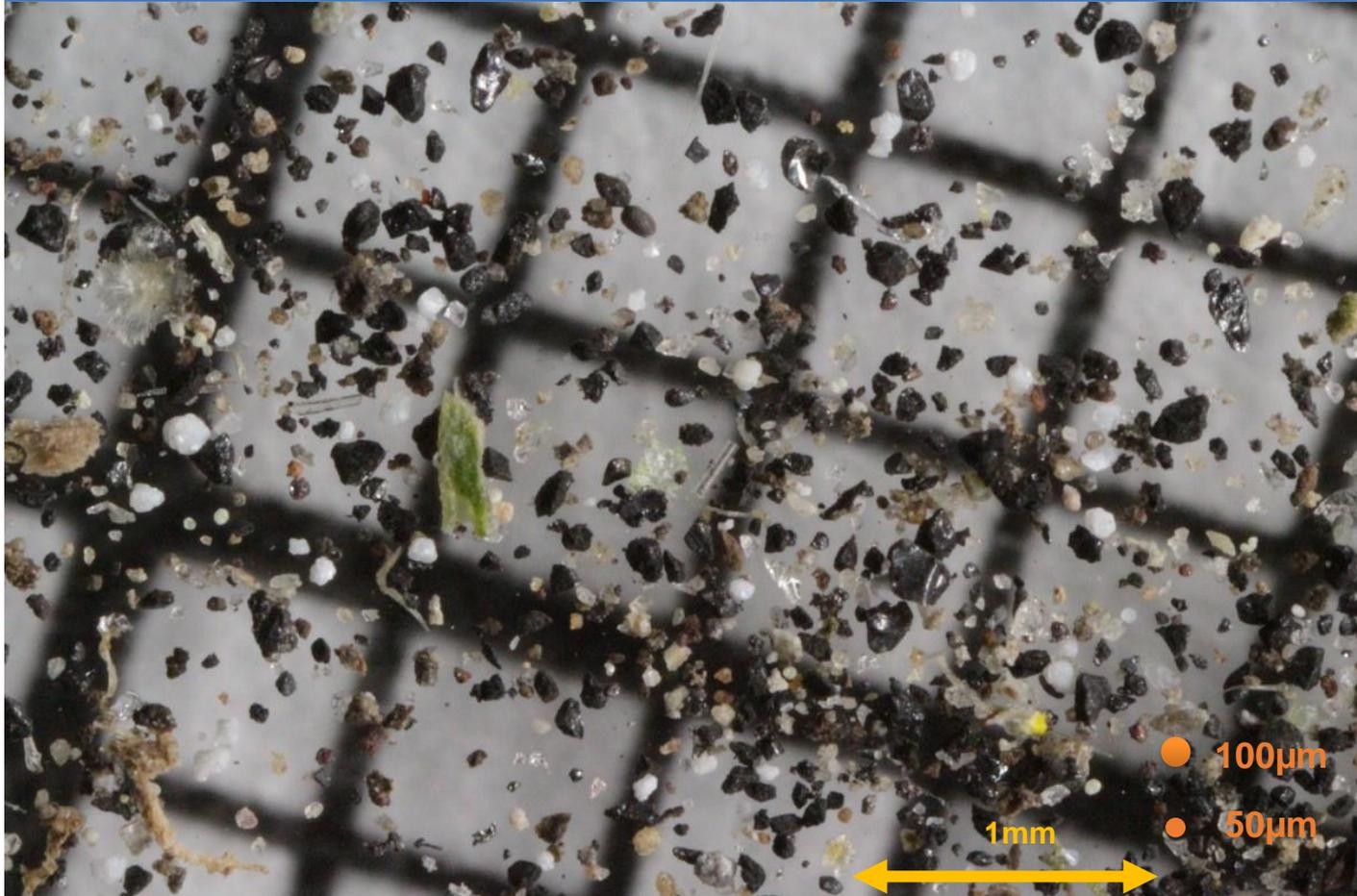
Cet échantillon est composé d'une population de particules de taille, allant de 20 µm à 200 µm.
