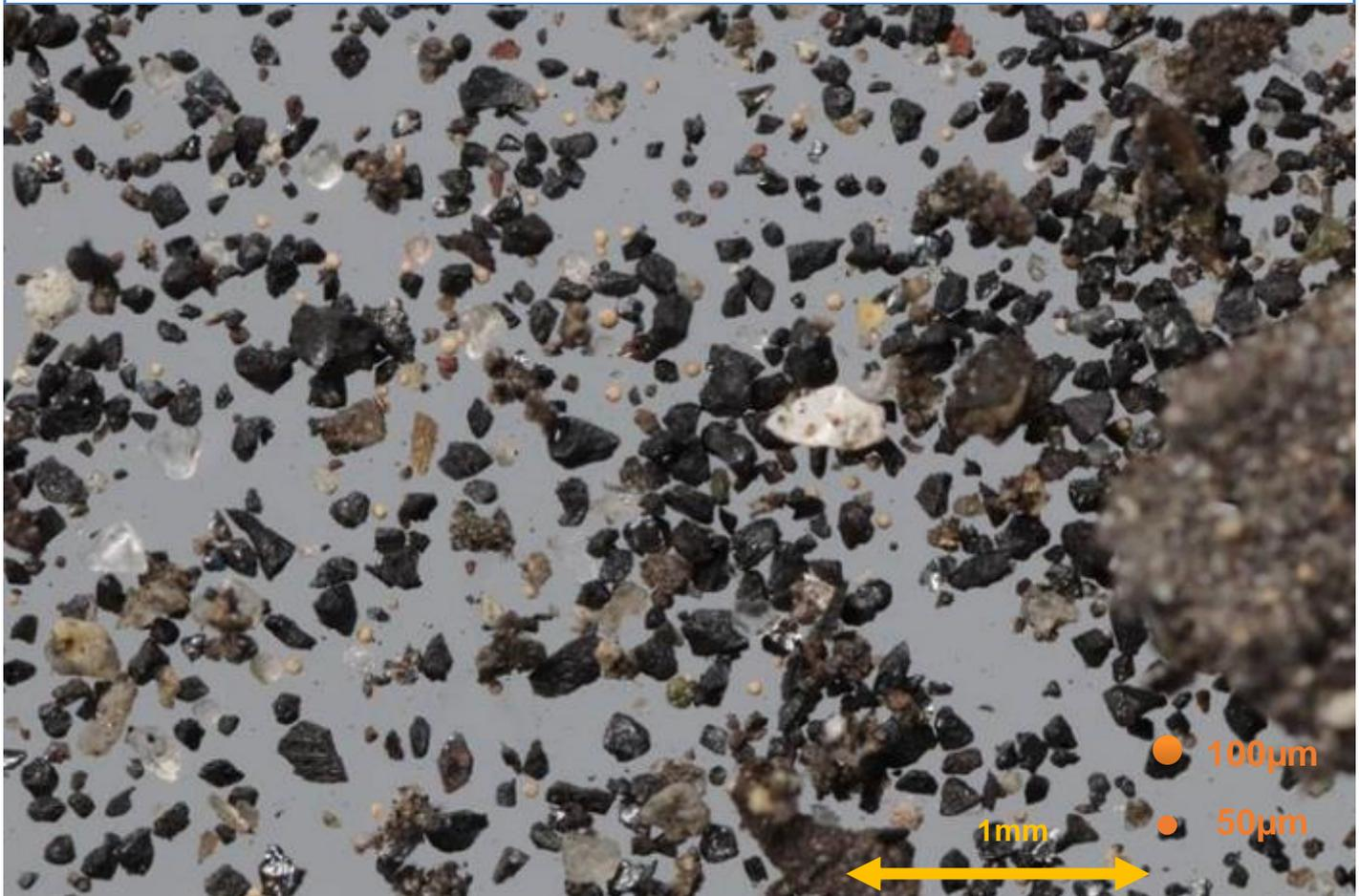
Cet échantillon est composé d'une population de particules de taille allant de 50 µm à 400 µm.
