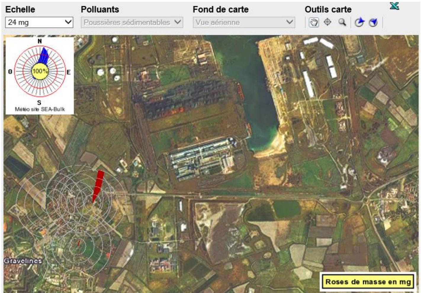
La rose de masse est obtenue en plaçant sur le graphe « radar » les valeurs moyennes en mg/m<sup>2</sup> mesurées pour chaque direction de vent.
