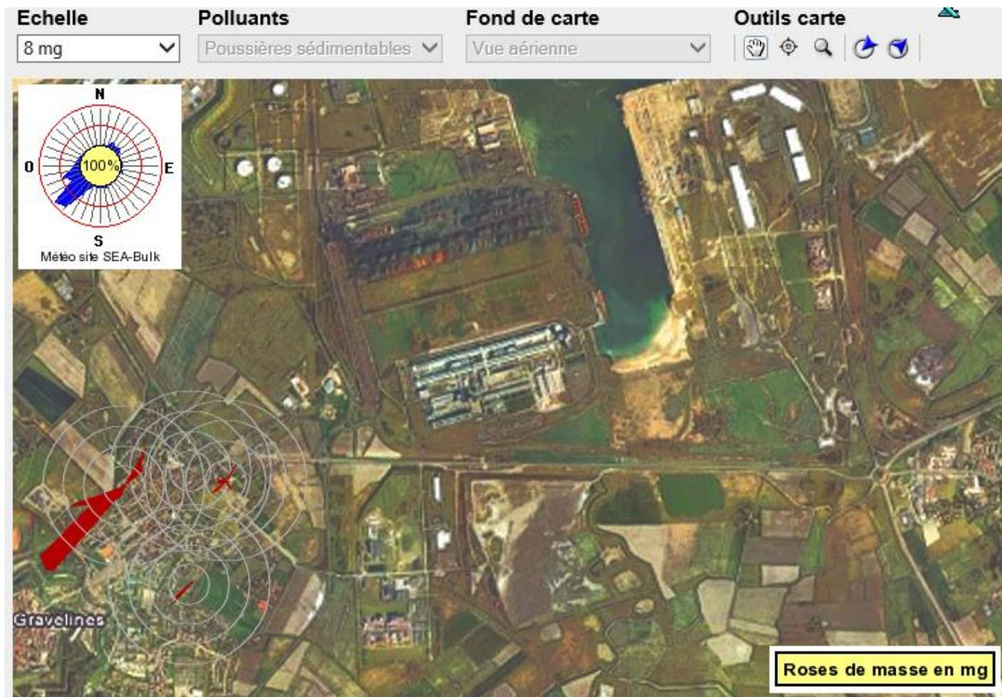
La rose de masse est obtenue en plaçant sur le graphe « radar » les valeurs moyennes en mg/m2 mesurées pour chaque direction de vent.
