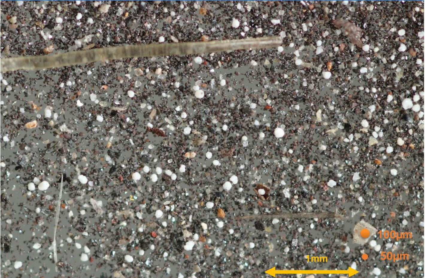
Cet échantillon est composé d'une population de particules de taille allant de 10 µm à 200 µm avec une grande proportion de particules d'une taille inférieure à 50 µm.
