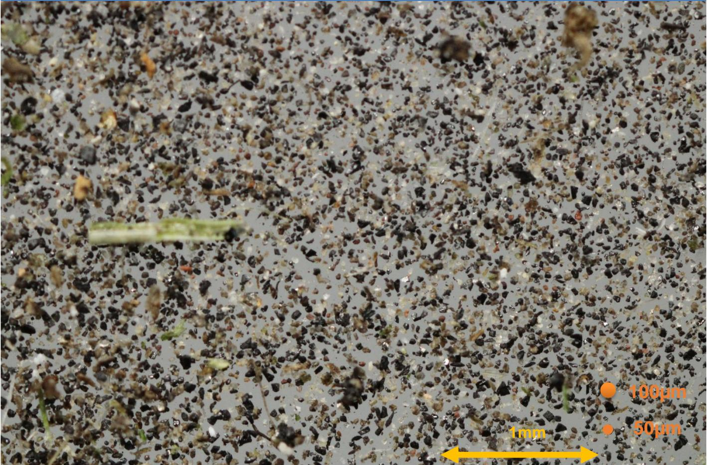
Cet échantillon collecté est représentatif de la déposition du 23 juillet dans l'après-midi. On note la présence majoritaire de particules d'une taille inférieure à 100 µm.
