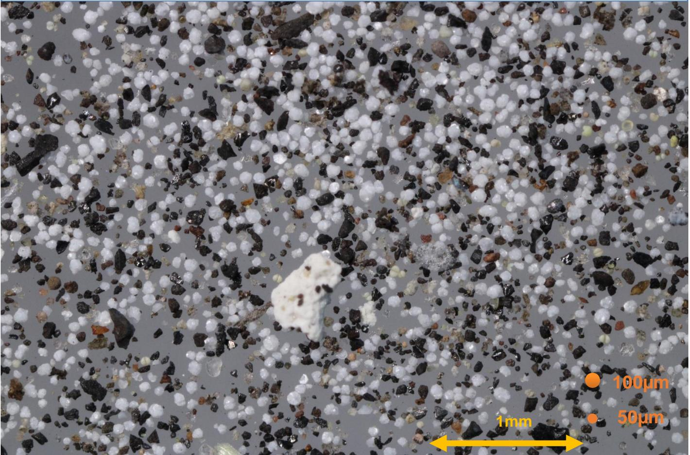
Cet échantillon est composé d'une population de particules de taille allant de 20 µm à 100 µm.
