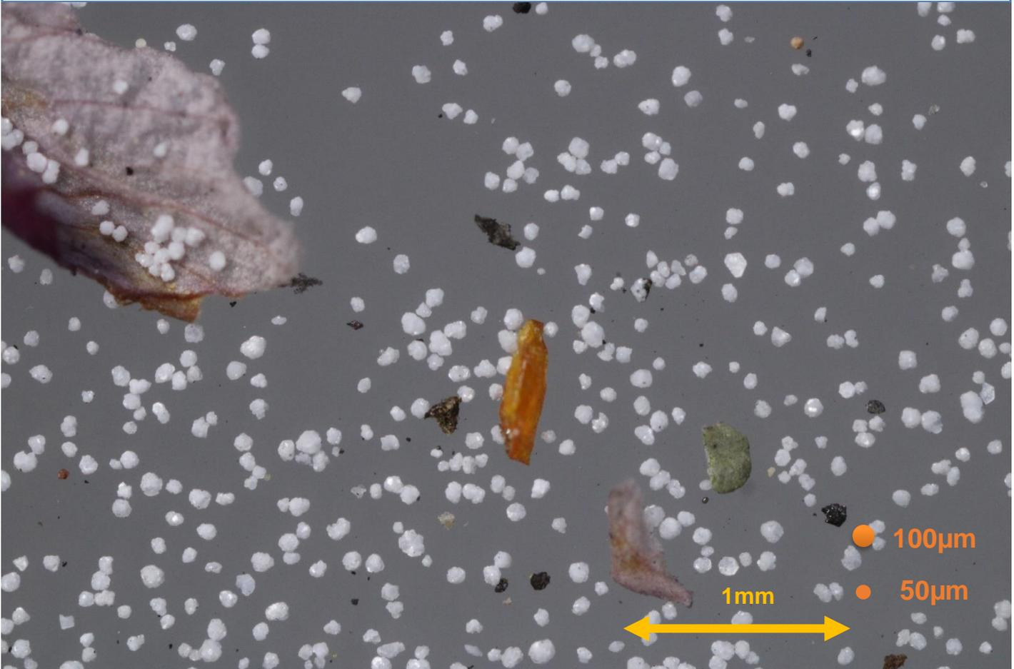
Cet échantillon est composé d'une population de particules de taille allant de 50  $\mu\text{m}$  à 100  $\mu\text{m}$ .
